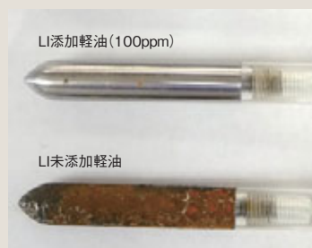
写真3 さび止め試験後の試験片の外観写真 JIS K 2510 8.1準拠 (試験温度：40℃)
