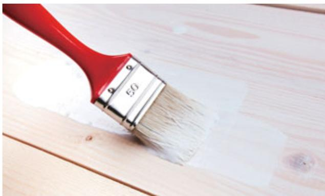
の二つのタイプに分かれます。溶剤系塗料は樹脂をシンナーなどの有機溶剤で溶かして作り、水系塗料は樹脂を水に分散させて作りま
