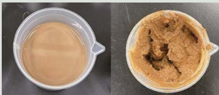
図7 表皮層用塗工液(左:分散性良好、右:分散性不良)
