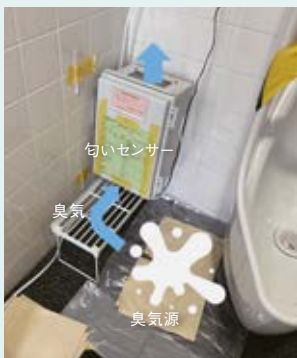
図8 小型機（開発品）を用いた社内トイレでの実験
