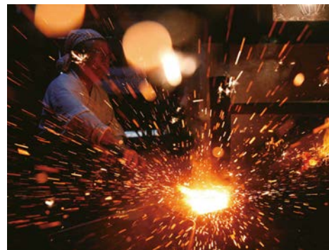
刀鍛冶がケラをたたいて玉鋼にする
