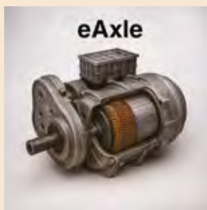
図1 eAxle:モーター、インバー ター、減速機といった駆動に 必要な部品を一体化したユ ニット
