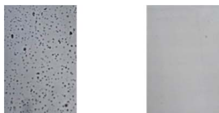
ハジキあり(従来品) ハジキなし(『ノプタム 3590 使用』) (OPPフィルム上にウェット膜厚 50 \mu m で塗布後乾燥)
