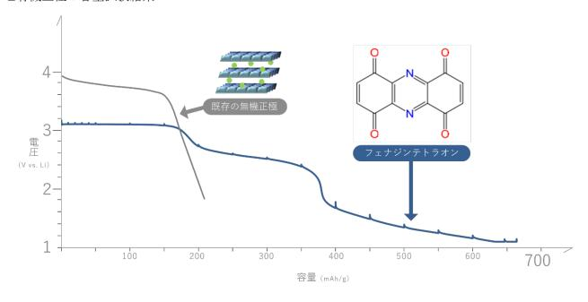
重量エネルギー密度は容量×平均作動電圧÷重量で表され、容量の改善は重量エネルギー密度改善の手段の一つ。フェナジンテトラオ ン  $(C_{12}H_4N_2O_4)$  を用いた有機正極二次電池のコインセルでの容量試験結果では、現行リチウムイオン電池に採用されている無機正極 の容量の約3倍の容量を持つ正極材料の実証を確認。 (右側へ行くほど正極容量が高くなることを示す)
