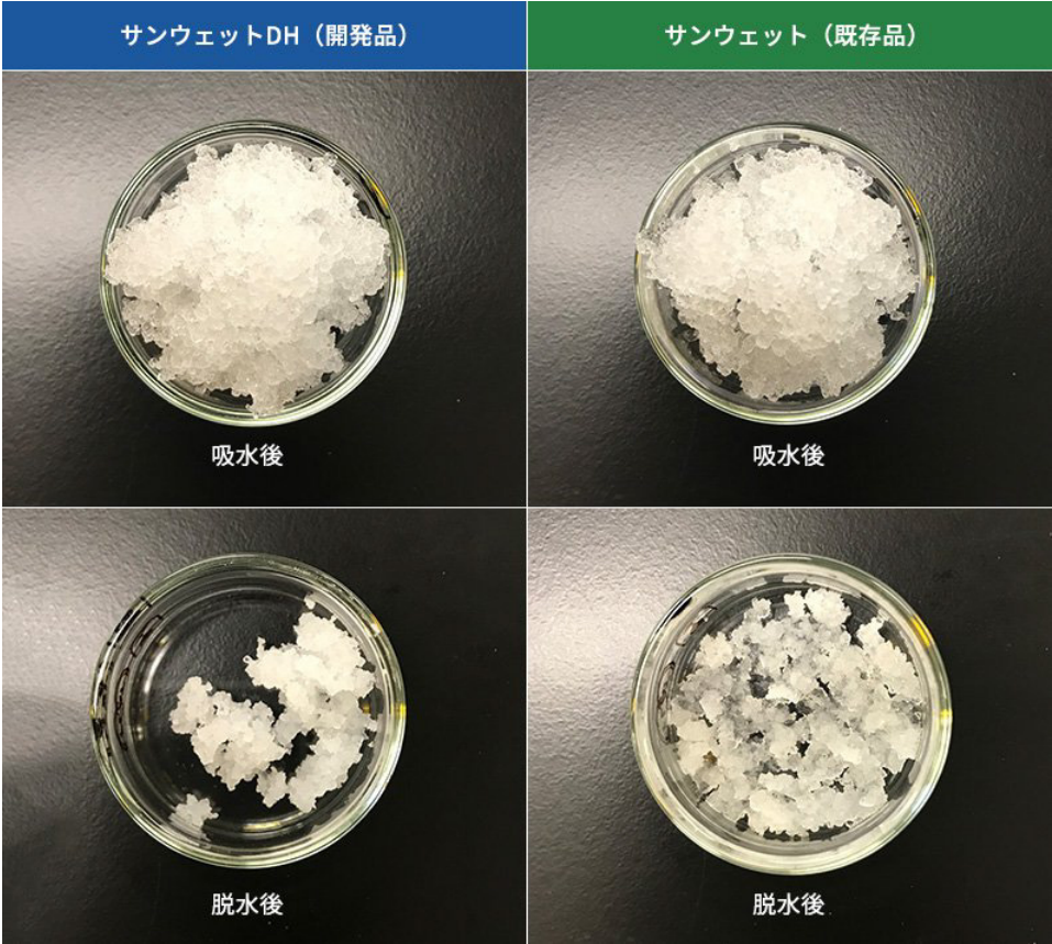
吸水したSAPを10分間塩化カルシウム水溶液に浸漬後、遠心分離機で90秒脱水
