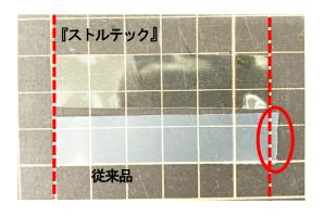
『ストルテック』は液状からフィルム状まで粘度や性状をカスタマイズでき、コーティングやプリント配線形成など各種プロセスに対応可能です。銅や銀など金属との密着性に優れており、配線板やセンサなどの封止材やフィルム基板<sup>※</sup>への活用が見込まれます。スクリーン印刷などによる印刷法が適用できると考えており、得られたフィルムは折り畳みや巻き取りも可能です。
