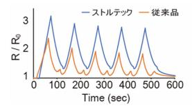
フィルム基板に印刷した導電感応層<sup>※</sup>が伸縮することで抵抗率が変化し、ひずみ具合を検知する。 50%ひずみ範囲で 0.2mm/sec でセンサを引張り、時間に対する抵抗値変化を測定した。
